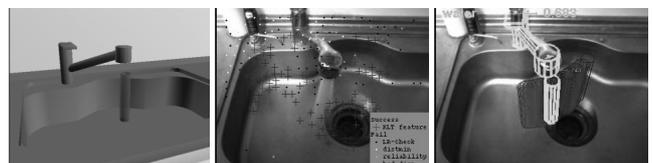
図7 三次元特徴点と環境知識を用いた水流の認識
