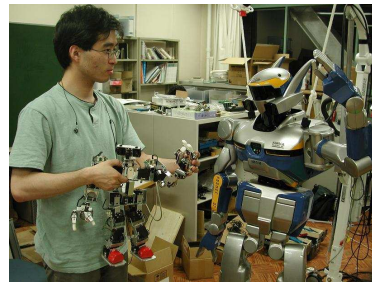
Fig.5 小型ヒューマノイドによる等身大ヒューマノイドの姿勢操作インターフェース例
